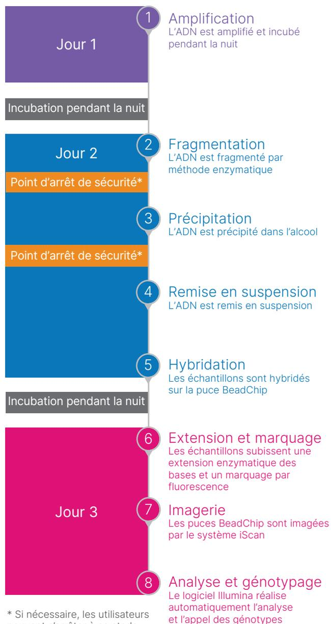
Figure 7 : La plateforme Infinium propose un flux de travail rapide de trois jours avec une durée de manipulation minimale.
