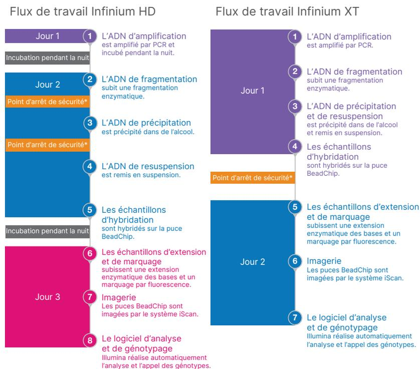
Figure 2 : Améliorations apportées au flux de travail Infinium XT. Chaque étape du flux de travail Infinium HD est optimisée dans le flux de travail Infinium XT, ce qui fait passer le temps de traitement de trois à deux jours.
